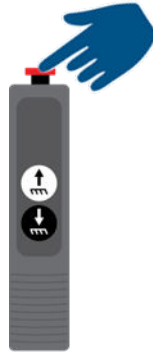
Figura 8. Attivazione degli arresti di emergenza
