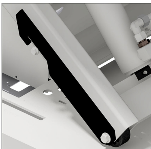
Figura 13. Blocco di manutenzione, posizione disattivata
