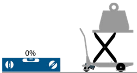
Figura 21. Posizionare il carrello a pantografo su una superficie piana con capacità di carico sufficiente
