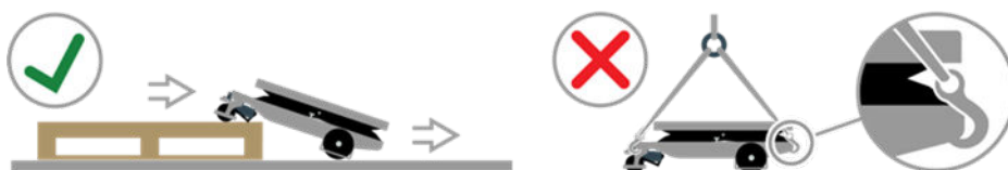
Figura 20. Non sollevare il carrello a pantografo
