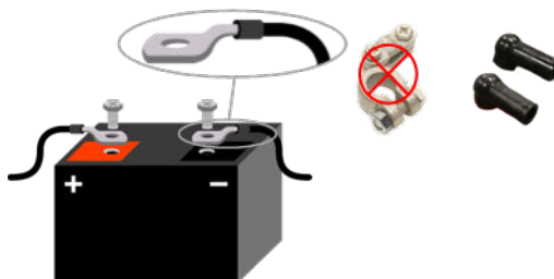
Figura 19. Montare il capocorda sul polo della batteria (prima il polo positivo), senza utilizzare il morsetto del terminale. Assicurarsi che il capocorda sia montato nell'orientamento corretto. Utilizzare i nuovi copriterminali.
